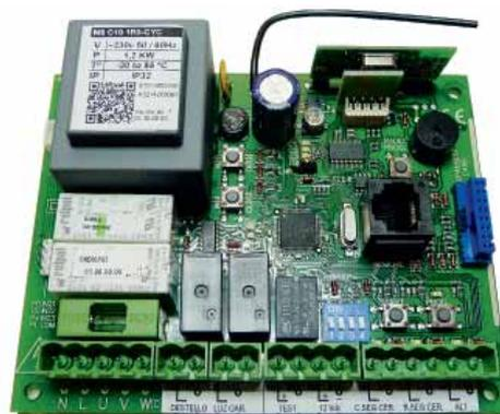
Protección entrada alimentación y motor mediante varistor y fusible 6A. Led indicador de red. Entrada de pulsador alternativo y contacto de seguridad.
