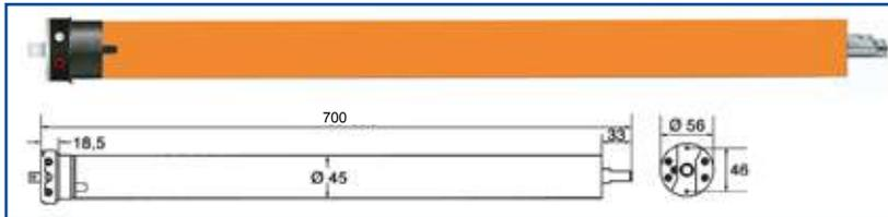
12MTSF453S2R Motor **Tauro 30R** Para eje de 60 $\phi$ . 30Nw.
